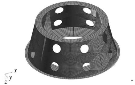
图3 振动试验夹具有限元模型
